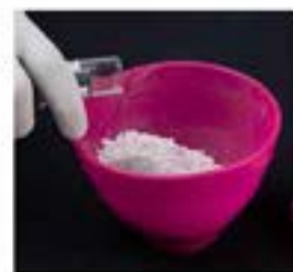
Passo 02 Despejar a medida em pó (10 g) e em seguida adicionar a água (19 mL)
